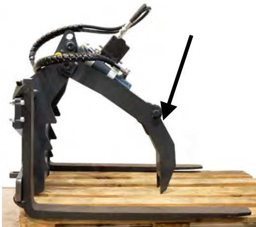
Lagerungsposition des Holzgreifers mit Palettengabel
